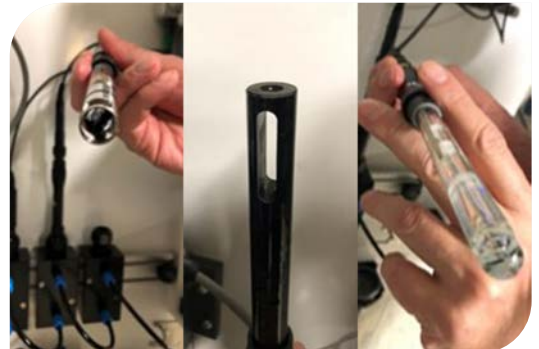
Abb. 3: Sensoren nach fünf Monaten Betrieb (Links: Sauerstoffsensoren, Mitte: Leitfähigkeitssensoren, rechts: pH-Sensoren)
